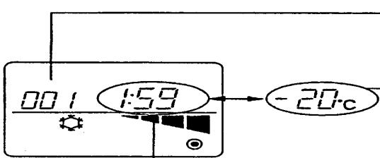
Адрес внутреннего прибора и температура трубы на дисплее
